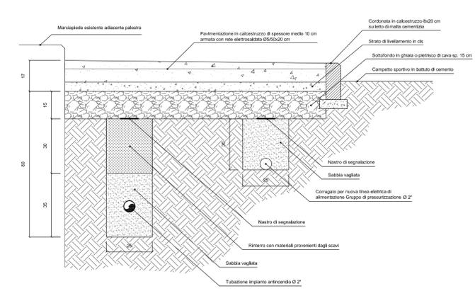
**SEZIONE DI DETTAGLIO B-B**
